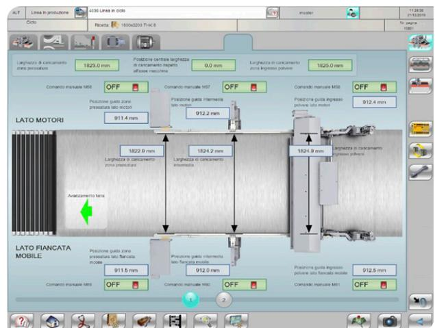
Grazie al nuovo sistema motorizzato delle guide, la regolazione della conicità in ingresso PCR diventa ora molto più semplice. L'interfaccia della PCR ha una pagina dedicata dove vengono mostrate le posizioni degli attuatori ed il loro funzionamento. Il sistema garantisce sempre un perfetto caricamento e densità dei bordi della lastra.
