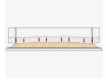
Une combinaison d'actionneurs électriques gère, en temps réel et grâce à un logiciel sophistiqué, le chargement de la poudre pendant la production, sans besoin d'arrêts de ligne supplémentaires.
