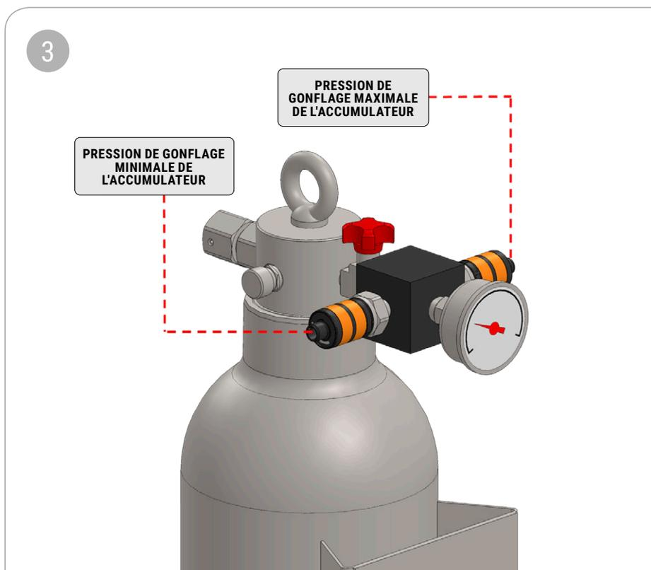
3. La mesure de la pression à l'intérieur de l'**accumulateur** PPB pour éviter les dommages et un **transducteur de pression** pour surveiller la pression de l'huile de l'unité de contrôle PPB par rapport à la pression d'atomisation, afin de détecter les fuites hydrauliques dans le circuit ;
