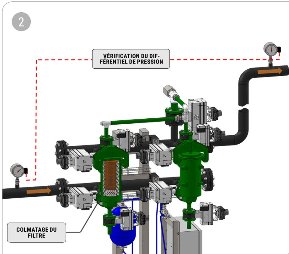
2. La mesure des pertes de charge dans les **filtres à barbotine** pour prévenir le colmatage ;
