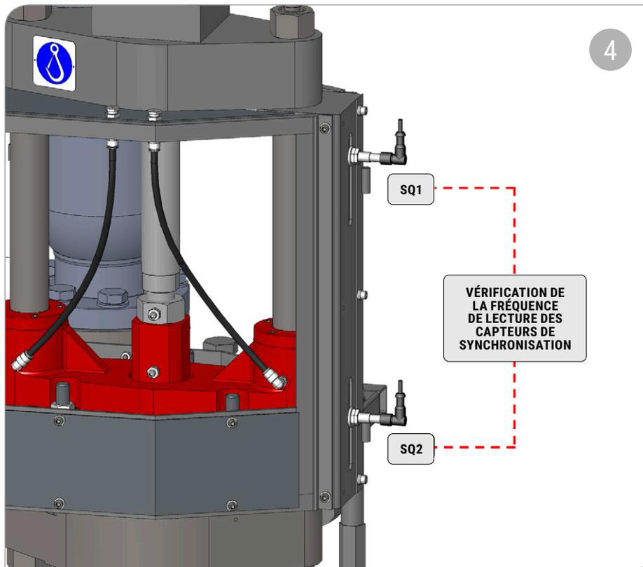
4. Un logiciel de contrôle du rephasage des pistons de la pompe PPB, pour garantir le réglage correct des capteurs d'inversion.
